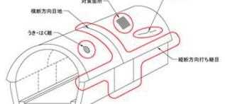
うき・はく離等の発生状況から、二回目以降の点検における打音検査の範囲を例示
