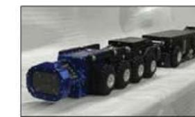
下水管路の欠陥を画像認識技術により自動検出するロボット
