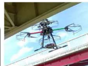
ドローンによる損傷把握
