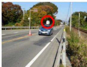
車載装置による路面性状測定
