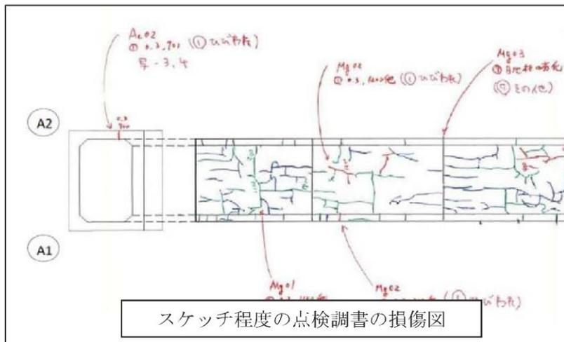
スケッチ程度の点検調書の損傷図
