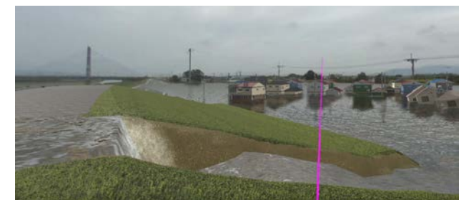
堤防が越水によって決壊していく経過をVRで体験する
