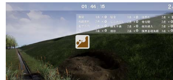
河川堤防VRの中で変状を点検する
