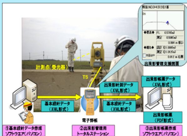
(TLSによる出来計測のイメージ)
