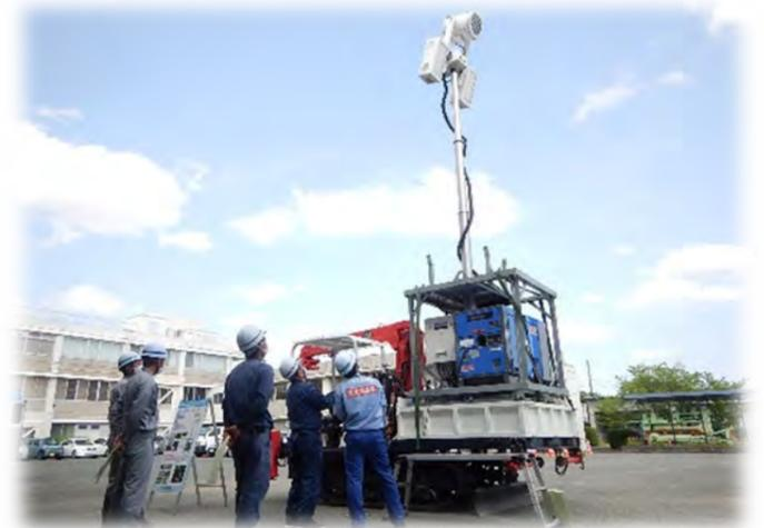
リモコンによるポールの伸張、照明の旋回、俯角操作を実施
