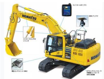
10 3Dテクノロジーを用いた計測及び誘導システム
