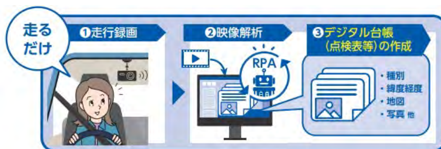
図2. 附属物点検表作成サービス「みちてんスナップ」の概要
