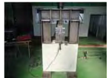
写真5 RC平板供試体による継手金物引張試験
