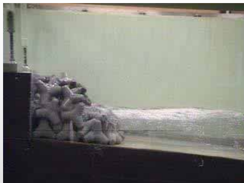
B.消波ブロック被覆護岸
