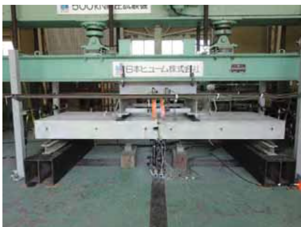
写真4 RC平板供試体による継手曲げ試験状況
