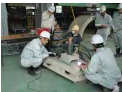
吊手金具引抜き試験
