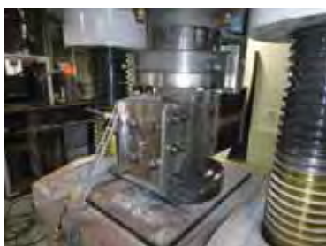
写真3 継手金物単体挿入試験
