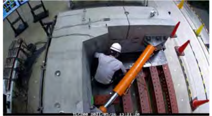
隅角部交番載荷試験
