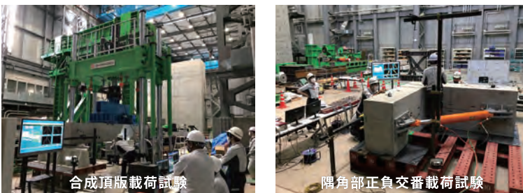
写真 3 ■コンポジットカルバート部材構造試験状況
