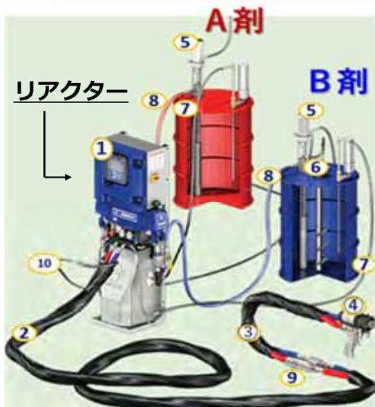
・ A剤（イソシアネート）とB剤（アミン）をコンピュータ制御されたリアクターにて、ホース末端のスプレーガンまで加熱圧送します。
