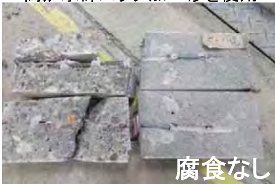
母材コンクリートの塩分含有量 15kg/m 3
