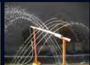
注入外管吐出状況
