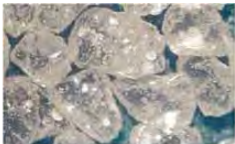
スラグ細骨材 (形状改善が成された状態)
