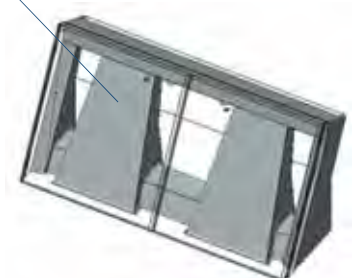
中詰めコンクリート充填
