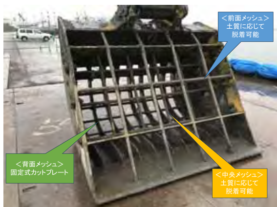
図-4 カルシアバケットCB30型の全景
