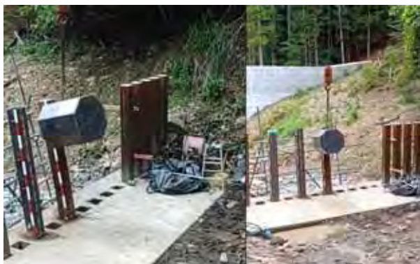
CFT柱上部正面への衝突状況
