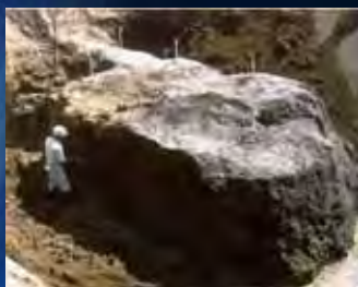
超多点注入工法による固結状況
