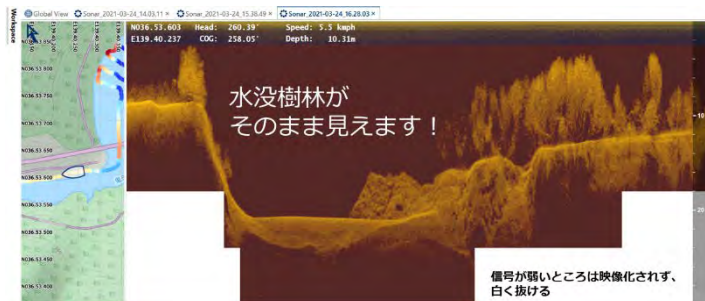
図—2 ソナーマッピングデータ処理の事例 (左：航跡、右：成果図・等高線図)
