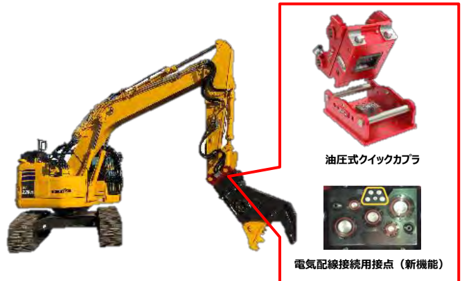
(図-4: 油圧ショベル用油圧式クイックカブ)
