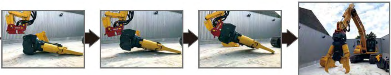
(図-5: 油圧ショベル用油圧式クイックカブラ着脱風景)
