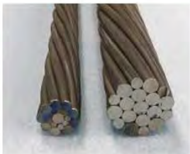
ポステン桁等の太い鋼材
