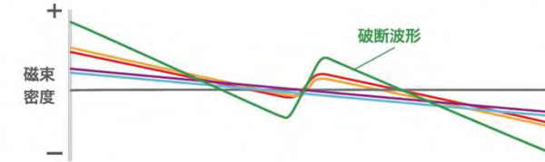
漏洩磁束法の健全と破断波形のイメージ
