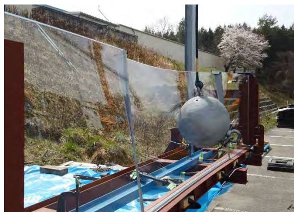
300kg突起付き鉄球を衝突させたときの状態 (※想定外の荷重に対する確認実験)
