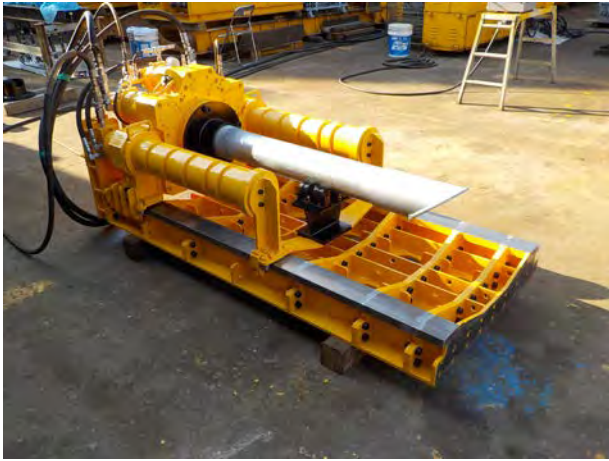
写真-1 アリトン工法(アリトンベーシック)
