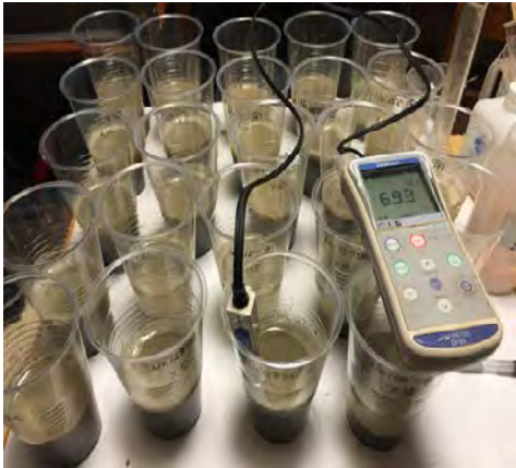
写真上：中和試験状況
