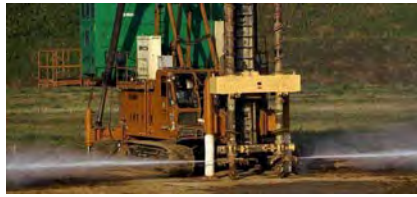
三点支持式杭打機や ボーリングマシン
