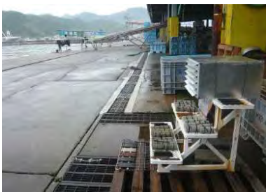
フィールド実験 (テストピース曝露試験)
