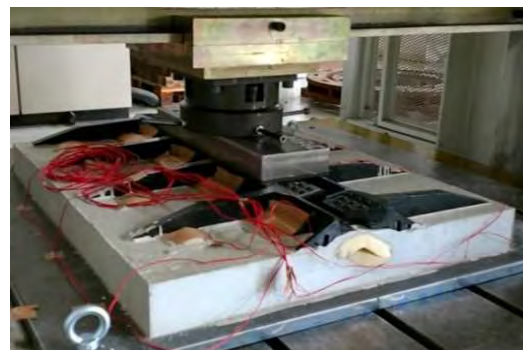
荷重支持プレートへの載荷による止水材脱落防止の検証
