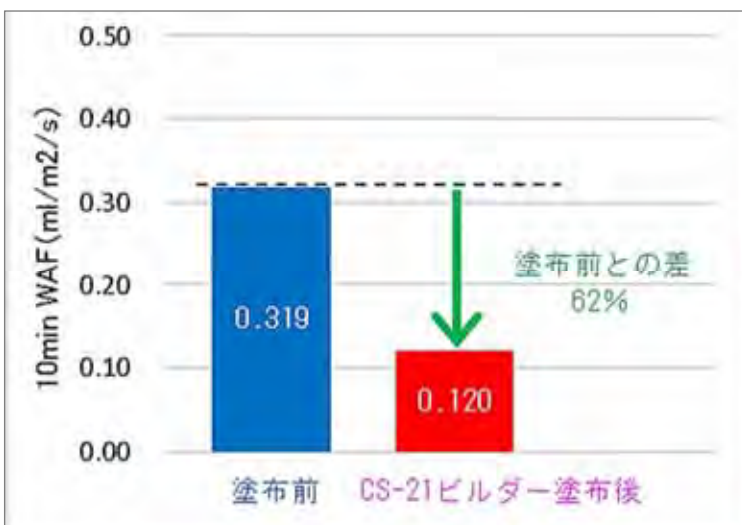
グラフ：表面吸水試験の結果
