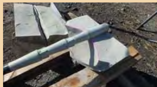
先端部は球面状に破断
