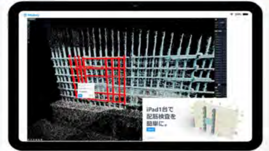
3次元データを活用した配筋検査省力化ツール「Modely」
