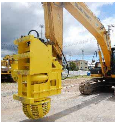
写真-1 T-A Dredgerの装着状況
