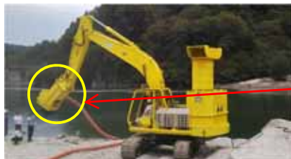
水深0～2m 水陸両用バックホウ取付例
