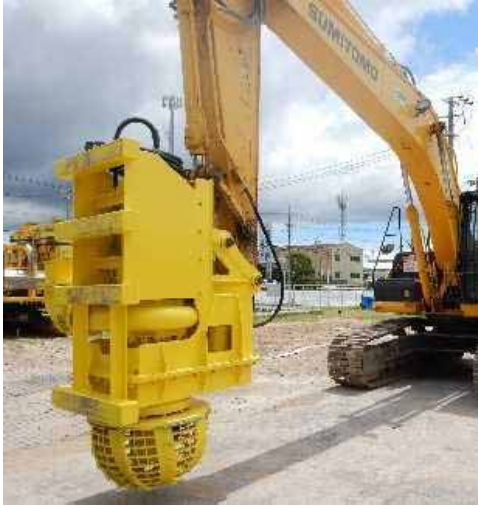
T-A Dredgerの建設機械への装着状況
