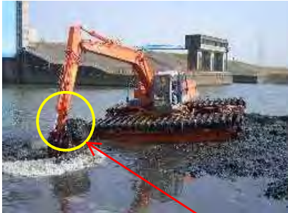
水深0～2m 水陸両用バックホウ取付例
