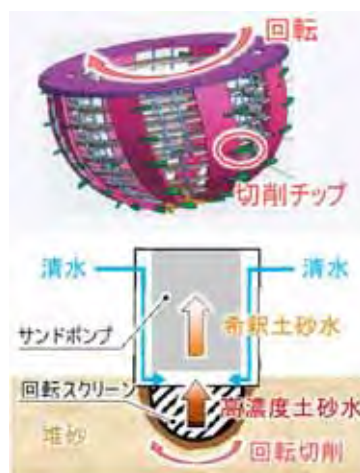
図-2 T-A Dredgerの浚渫方法
