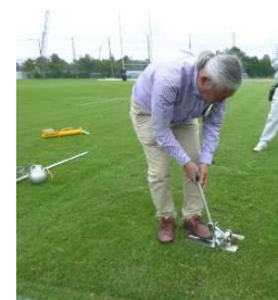
垂直せん断抵抗力試験 ワールドラグビー(WR)基準により評価。 WR基準値: >60Nm ※特にラグビーではスクラム等の時垂直方向への支持力が芝に求められる。
