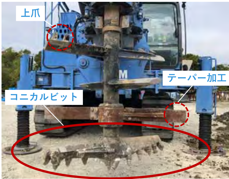
硬質層対応攪拌翼
