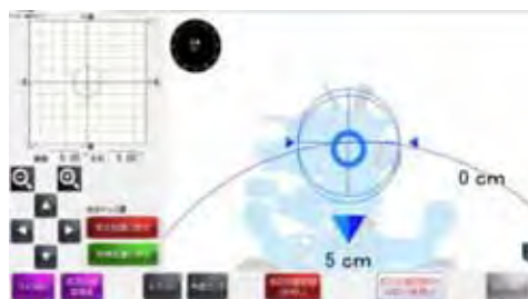
杭誘導モニター
