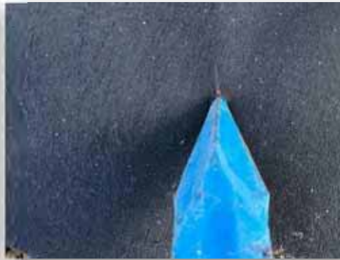
■突刺すことでシートの開口と植穴掘削を同時に行う
