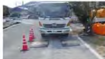
簡易ポータブル計量器での測定状況
