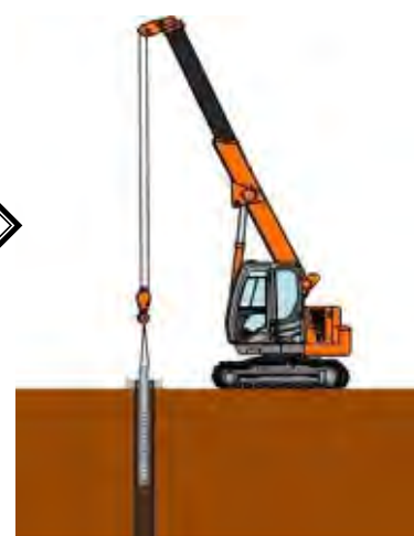
水中ポンプ設置 (φ100深井戸用ステンレス製)
