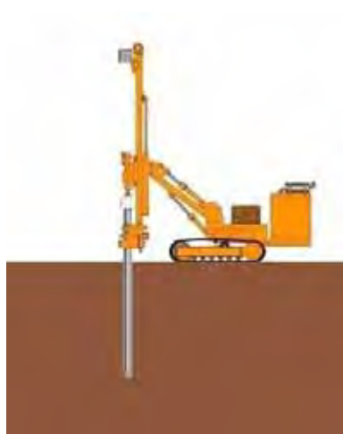
ロータリーパーカッションドリル (φ200 二重管削孔)
