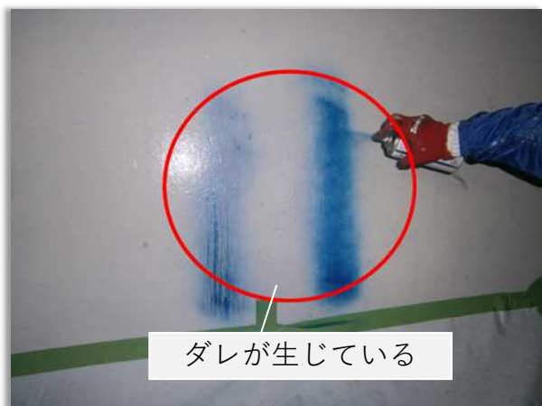
文字の原型をとどめず「ダレ」が生じている。
