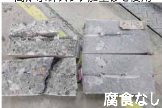
母材コンクリートの塩分含有量 15kg/m³
