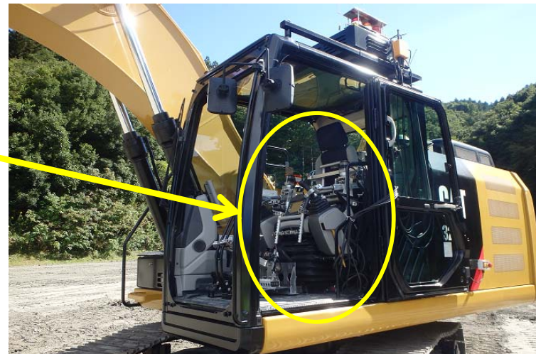
簡易遠隔操縦装置の設置状況
