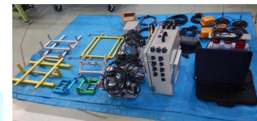
簡易遠隔操縦装置の分解状況
