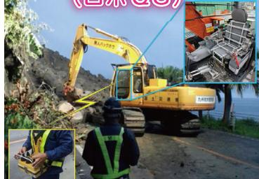
2次災害の恐れがある危険な現場でバックホウを遠隔操作します。
