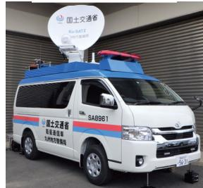
通信衛星システムを利用し、災害現場の映像などの情報を伝送します。
