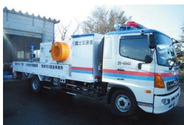
車両に水中ポンプを搭載し、浸水被害が発生した箇所での排水運転を行います。
