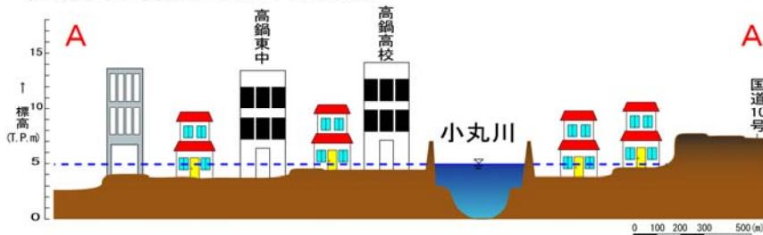
図 1-1-4 小丸川堤内地盤横断図
