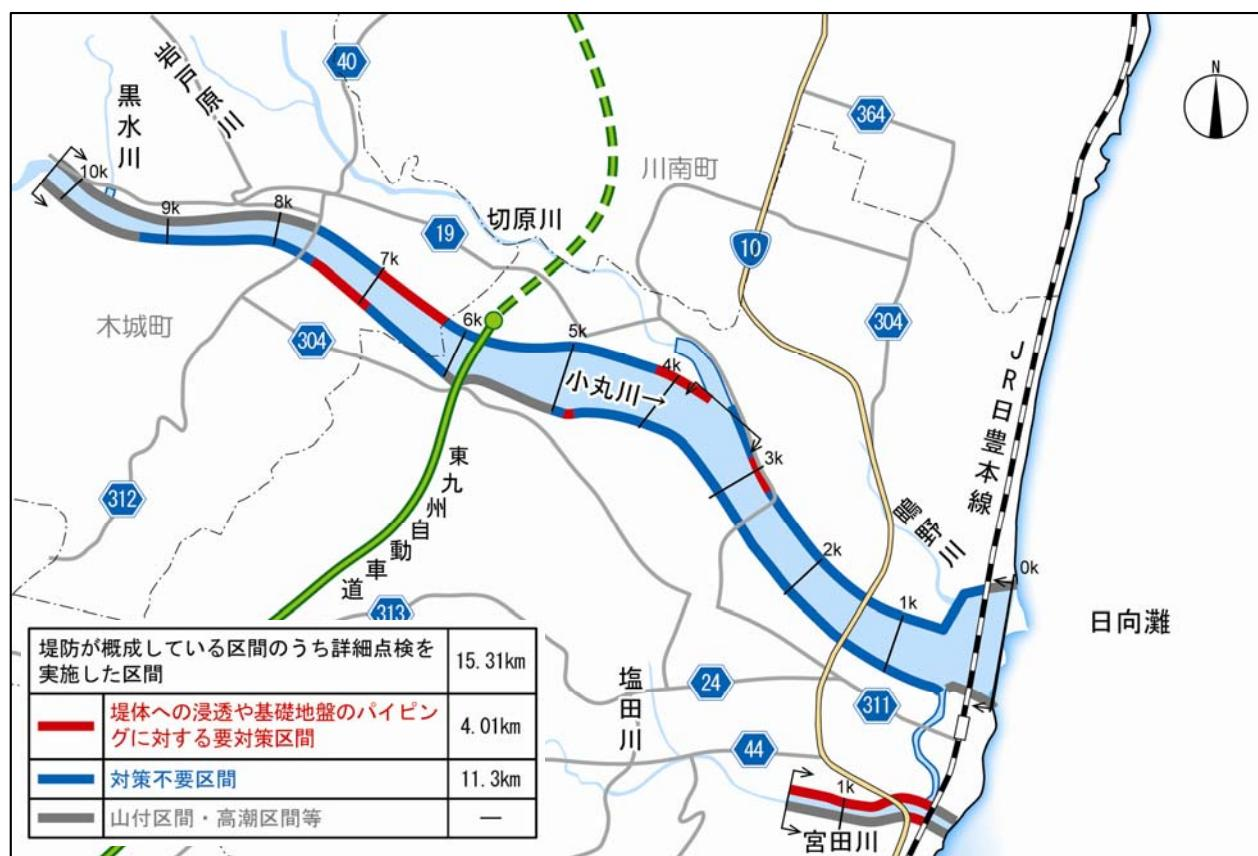
図 2-1-2 堤防詳細点検結果図
