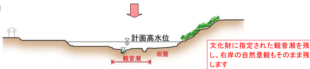
図 5.1.6 河道掘削の概要図(大淀川 51/050 付近)
