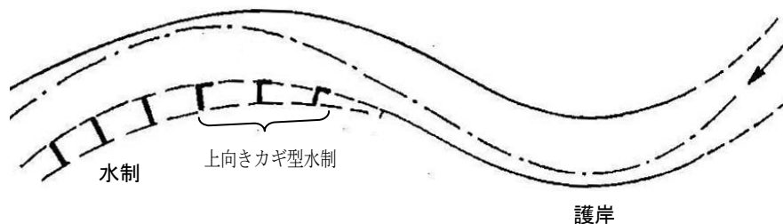
図-9 護岸から水制に移行していくシステム 2)
