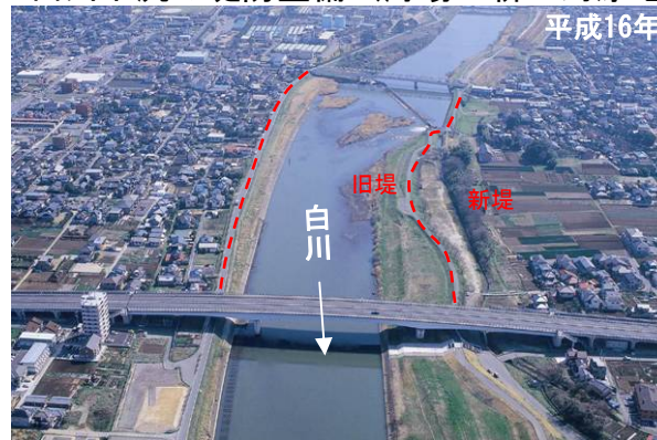
うすば しんとがわら 白川下流の堤防整備（薄場・新土河原地区）
