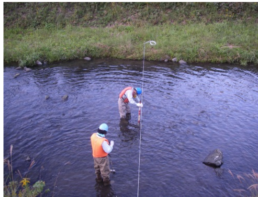
流量観測状況
