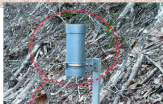
赤-6 傾斜崩壊センサー
