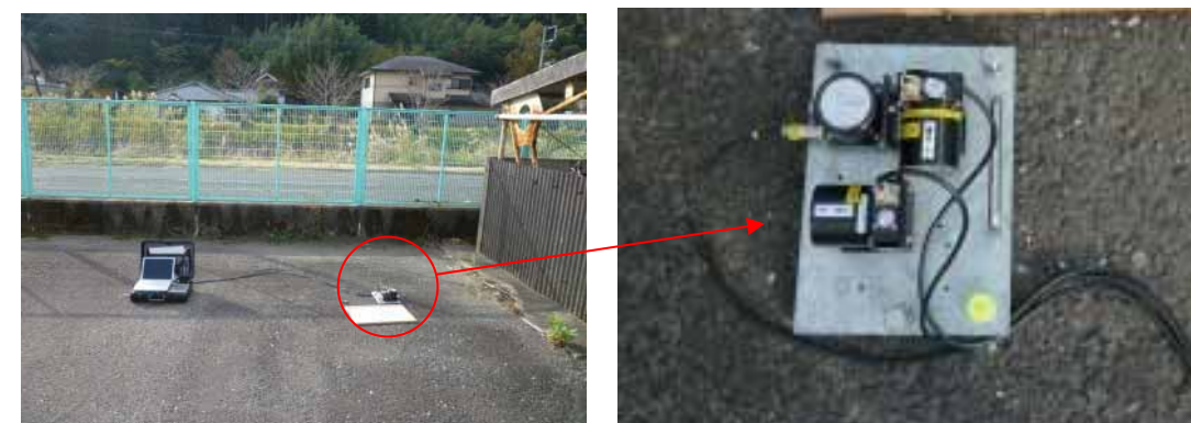
図2 常時微動測定装置例
