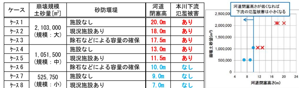
図4 シミュレーション結果による河道閉塞高さと本川下流氾濫被害の有無
