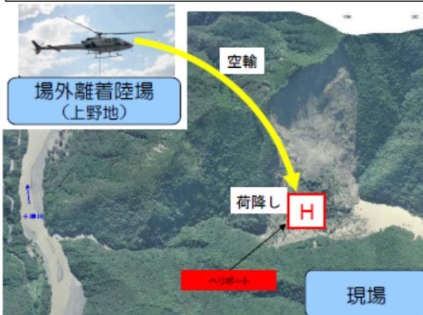
図6 分解型重機の活用（長殿・栗平）（近畿地方整備局資料より）
