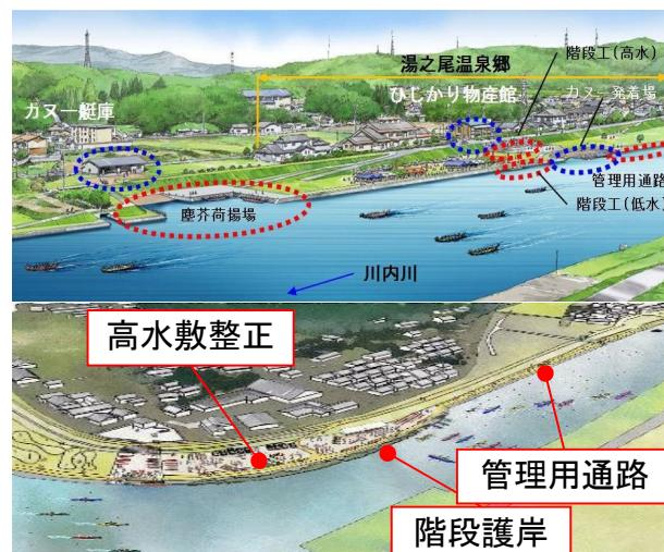
国整備:塵芥荷揚場、管理用通路、階段、階段護岸、高水敷整正
