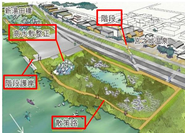
国整備：散策路、階段護岸、高水敷整正、階段
