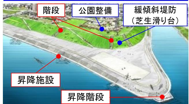
国整備: 昇降施設、昇降階段、階段、緩傾斜堤防
