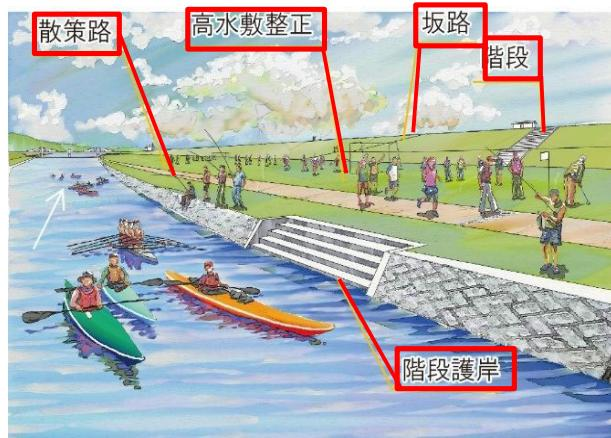
国整備:散策路、高水敷整正、坂路、階段、階段護岸
