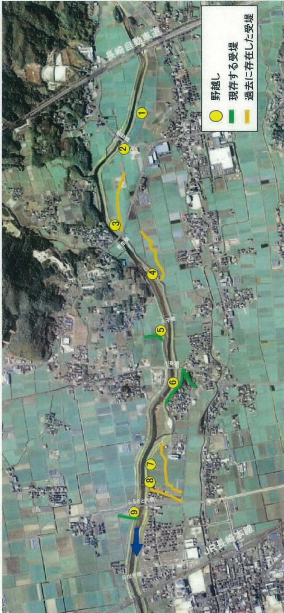
**治水対策案⑨「遊水地（地役権方式）＋河道の掘削＋部分的に低い堤防の存置」
