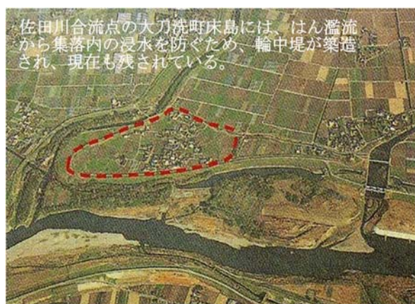
写真 2.2-2 佐田川合流点の輪中堤(大刀洗町)
