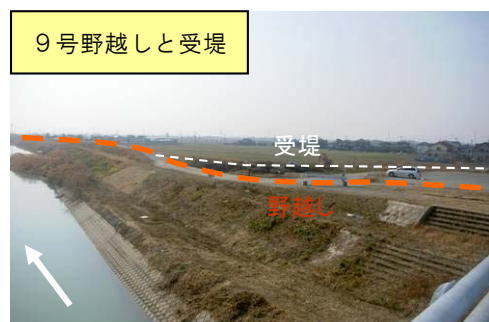
写真 2.3-3 野越しと受堤の位置
