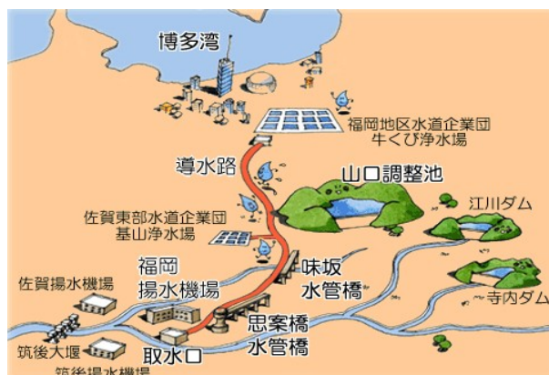
図 2.2-4 福岡導水模式図
