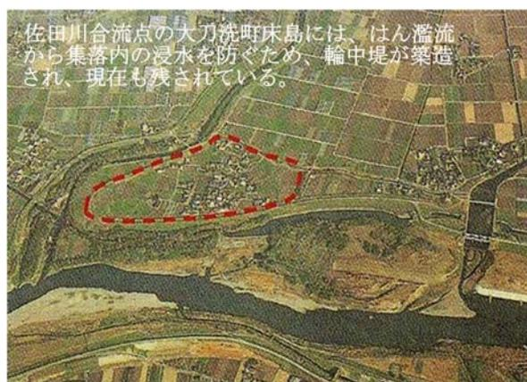
写真 2.2-2 佐田川合流点の輪中堤(大刀洗町)
