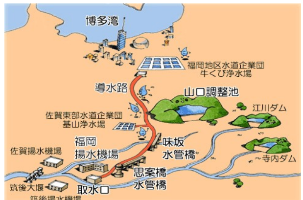
図 2.2-2 福岡導水模式図
