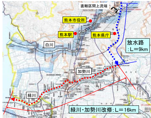
放水路ルート
