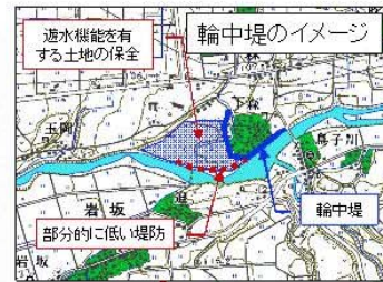
遊水機能を有する土地の保全 輪中堤のイメージ 部分的に低い堤防 取
