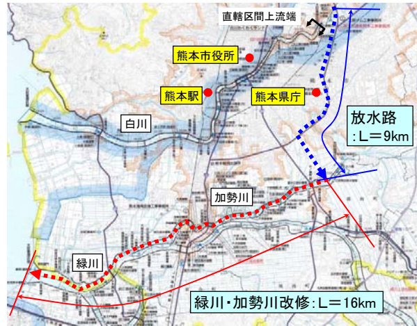
放水路ルート
