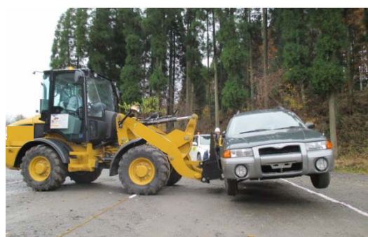
ホイールローダによる車両移動 (アタッチメント装着)
