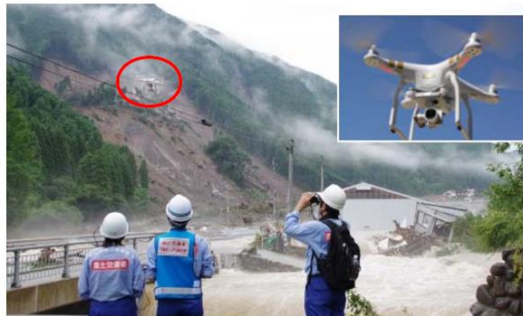
図2-75 被災直後の災害実態把握に活用されるドローン
