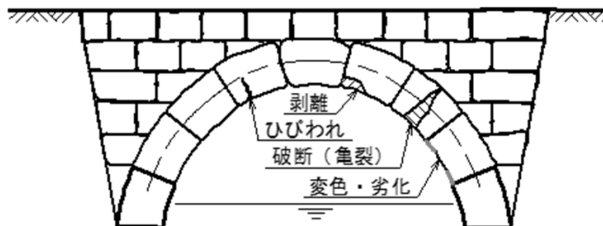
図1.15-1 石材単体の変状事例
